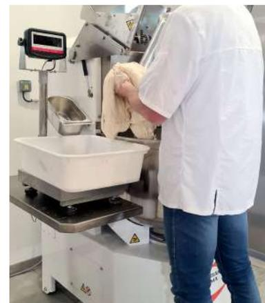
Per facilitare ulteriormente il compito dell'operatore, un dispositivo meccanico assicura che **i bracci si fermino sempre in posizione sollevata ogni volta che** l'apparecchiatura si ferma, consentendo un migliore accesso per lo svuotamento o la pulizia del serbatoio.
