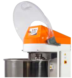
3 Sécurité : quand le couvercle est relevé, le pétrin s'arrête automatiquement.
