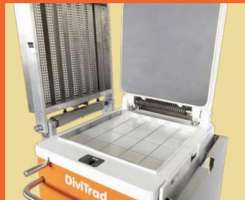
Avec sa cuve de 400x400 mm, DiviTrad® Compact est équipée de couteaux permettant une découpe en 20 pâtons carrés. Elle permet aussi bien la division «classique» avant fermentation que la division «tradition» pour former des baguettes et cuire immédiatement.
